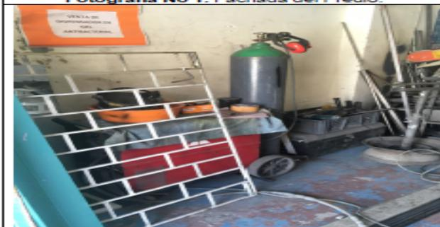
Fotografía No 3. Equipo de soldadura.
